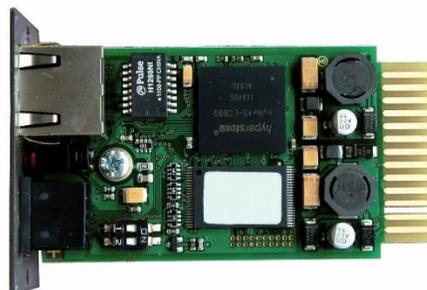
Dies ist eine Ethernet-Netzwerkkarte mit TCP/IP-, HTTP- und SNMP-Protokoll.
