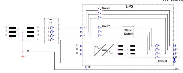
In Normalbetrieb sind SWBY und SWOUT geschlossen. Das Öffnen des SWBY beeinflusst nicht das Potential des Ausgangsneutralleiters.
