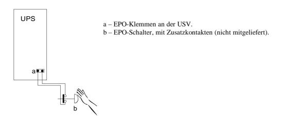
Die Taste muss mit einem Zusatzkontakt ausgestattet sein. An der USV muss die Überbrückung an den EPO-Klemmen entfernt werden. Anstelle der Brücke müssen die vom Zusatzkontakt der Taste kommenden Kabel angeschlossen werden.
