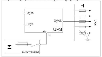
Bei <u>Netz-Stromversorgung</u> muss die Sicherung am Ausgang selektiv mit der Sicherung am Eingang sein. Dieser Zustand ist mit folgenden Werten überprüft:
