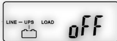
2. Schalten Sie den Bypass-Eingang und den normalen Spannungseingang mit den entsprechenden Schaltern aus.
